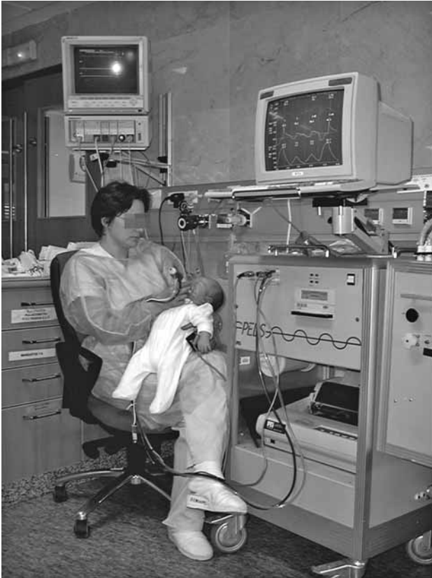
Figura 2. Neumotacógrafo convencional, con sistema de manometría esofágica y capacidad residual funcional por Helio.
