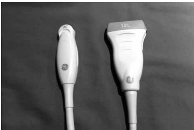
**Figura 1.** Transductores empleados. A la izquierda tipo Microconvex de 8 Hz y a la derecha tipo Lineal de 12 Hz.
